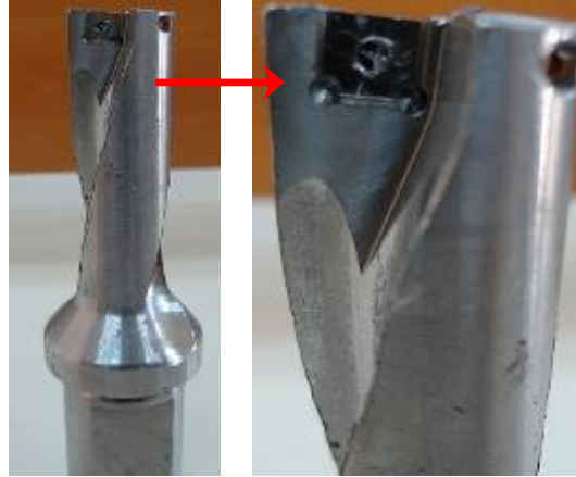
Şekil 3: Takma uçlu matkapta yanlış programlama sonucu uç yuvalarında oluşan operatör hatası
