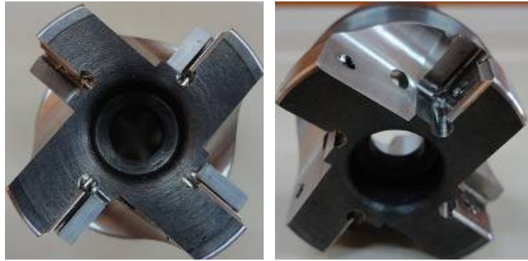
Şekil 5: Takma uçlu freze kafasında uç yuvasında kesme açısı verilmemesinden kaynaklanan tasarım hatası
