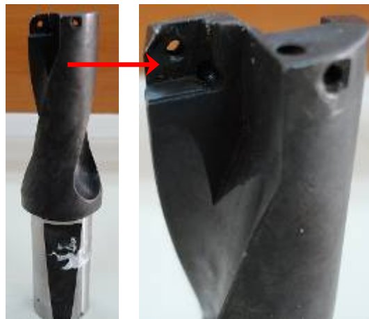
Şekil 2: Takma uçlu matkapta tezgâhın iş parçasına çarpmasından kaynaklanan operatör hatası
